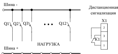
Рисунок 15.1 - Схема подключения щитов ЩРЗ-4-1
