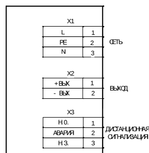
Рисунок 8.2 - Схема подключения выпрямителей ВБВ 60/2-2М, ВБВ 48/2-2М, ВБВ 24/4-2М, ВБВ 12/4-2М для самостоятельной работы (в кожухе)
