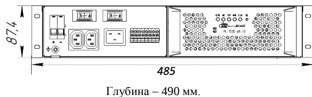
Рисунок 14.2.1 - Габаритный чертеж ИЦ-1500-24-БП-19, ИЦ-3000-48-БП-19, ИЦ-3000-60-БП-19
