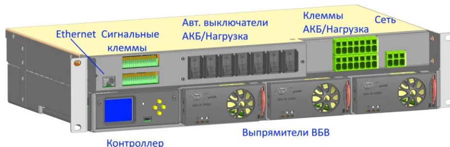
Рисунок 1.5 – Вид спереди и расположение клемм УЭПС-7К 48/66-33-1Т
