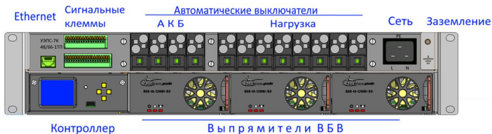
Рисунок 1.6 – Вид спереди и расположение клемм УЭПС-7К 48/66-33-1ТП
