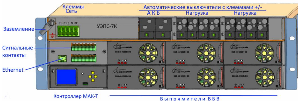
Рисунок 1.9 – Вид спереди и расположение клемм УЭПС-7К 48/132-66-1ТП
