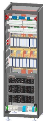
Рисунок 2.2 - Пример размещения компонентов внутри УЭПС-7 48/1344-2424+8.8 и УЭПС-7 60/1080-2424+8.8
