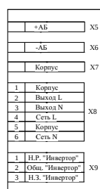
Рисунок 14.1.2 — Схема подключения ИЦ-600 БП-19
