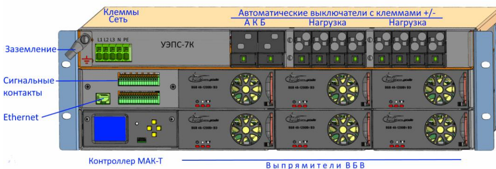
Рисунок 1.9 – Вид спереди и расположение клемм УЭПС-7К 48/132-66-1ТП
