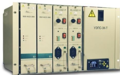
Рисунок 4.1 - Пример размещения инверторов ИЦ-600-3К в УЭПС-3К 60/80-42, УЭПС-3К 48/100-42 (ВЭ)
