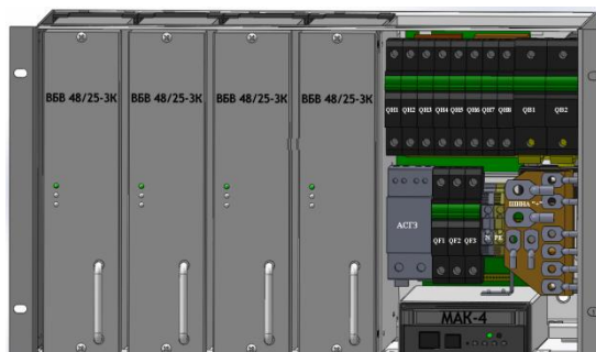
Рисунок 4.3 - Пример размещения компонентов внутри УЭПС-ЗК 60/80-44, УЭПС-ЗК 48/100-44
